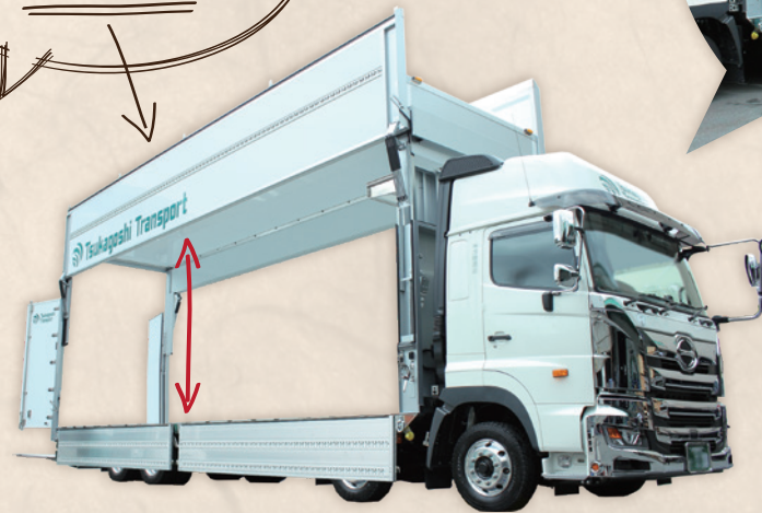
電動式大型リフトウィング車 (定温管理機能・パワーゲート付)
