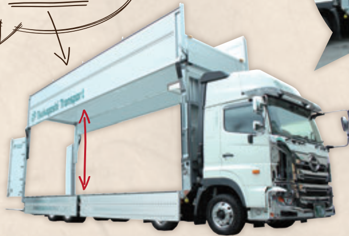
電動式10tリフトウィング車 (定温管理機能・パワーゲート付)
